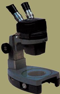
(۱-۶) شکل: ستریو مایکروسکوپ
